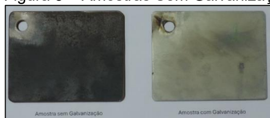
Figura 5 – Amostras Sem Galvanização e Com Galvanização
