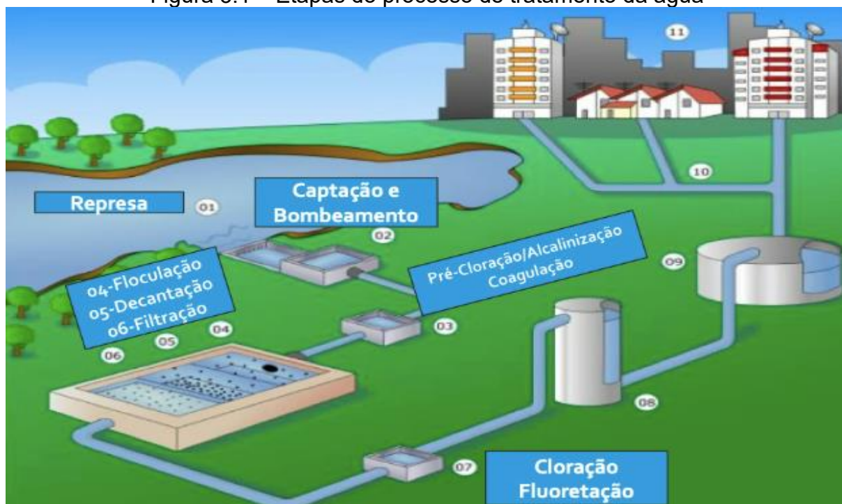
Figura 3.1 – Etapas do processo de tratamento da água
