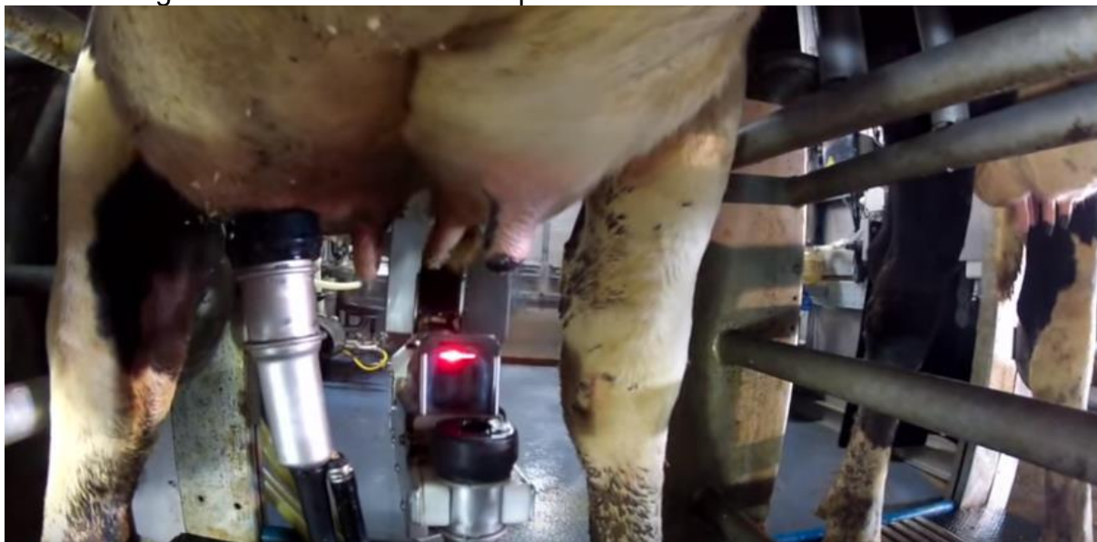
Figura 2.14 - Sensor atuando para encaixe das teteiras no animal
