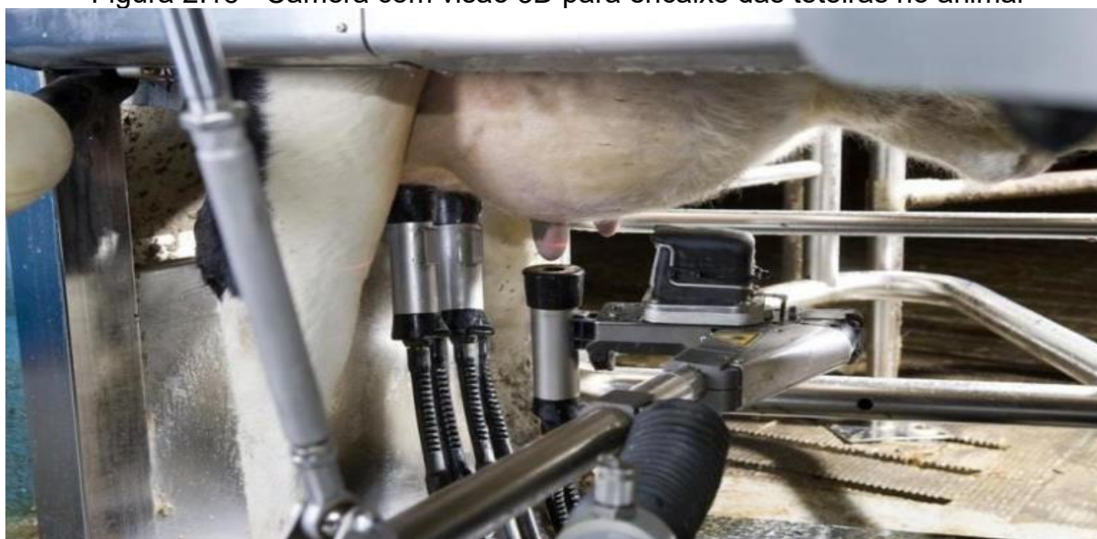
Figura 2.15 - Câmera com visão 3D para encaixe das teteiras no animal
