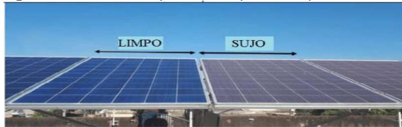
Figura 4.3: Antes e Depois da Limpeza nas placas solar
